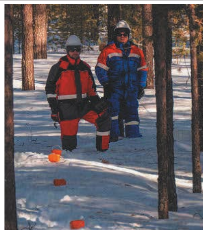
Рис. 6. Считывание сейсмической информации и одновременная зарядка встроенных аккумуляторов на стойках
